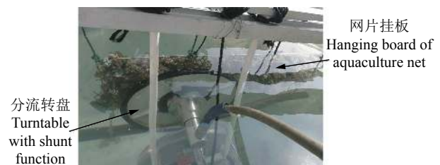
图4 挂板清洗试验工况
